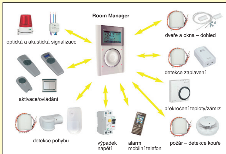
Obr. 3. Room Manager rovněž plní bezpečnostní funkce
